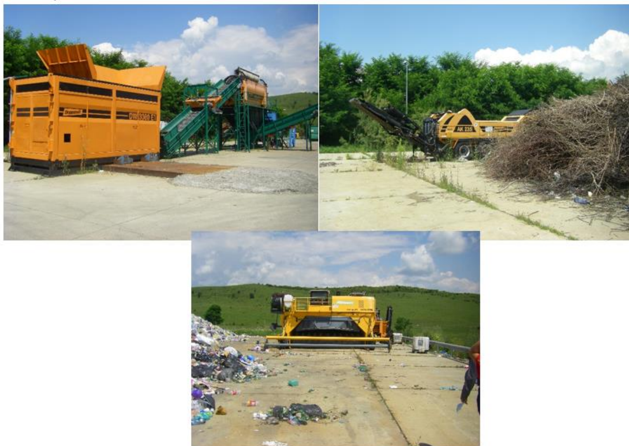
Figura 2-25 Stația de compostare a deșeurilor biodegradabile în cadrul CMID Tărpui
